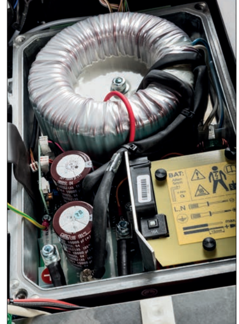
Blick ins Allerheiligste: Dieser schaltende Wandler erzeugt die Netz- aus der Batteriespannung
