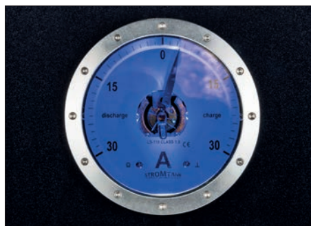
Die blaue Beleuchtung des Instruments signalisiert den On-Grid-Betrieb
