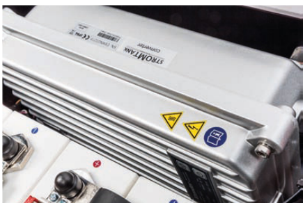
Maitinimo bloko elektronika sukonstruota ekranuotame lietaame korpusė
