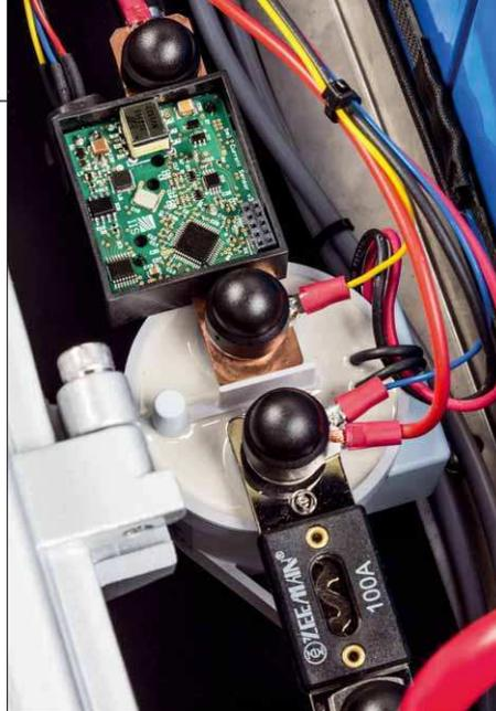
Für wenn mal was ist: Die Sicherung spricht an, wenn's für das große Relais mal zu schnell gehen sollte
