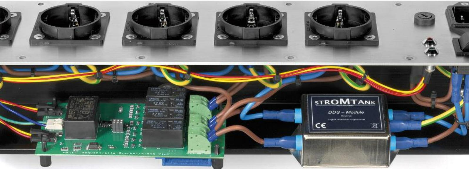
Sehr durchdacht (und genau deshalb auch nicht einsehbar): Das silberne Kästchen an der Geräteunterseite beherbergt das sogenannte DDS-Modul, eine Art Filter, der Einstreueffekte von Digitalgeräten verhindert. Dies geschieht ohne Dynamikverluste, weil dabei nur die Trägerfrequenzen „bearbeitet“ werden, nicht aber das Sinussignal selbst
