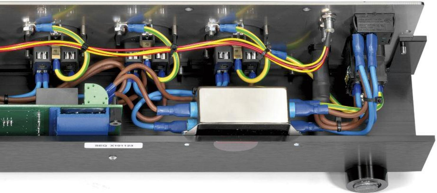
Sternförmig verdrahtet, kontaktstark: Beste Verbindungen und eine Mischung von Reinkupferkabeln verschiedenen Querschnitts, die sich bereits in anderen Stromtank-Geräten bewährt hat, sollen für Musikalität, Präsenz und Schnelligkeit sorgen
